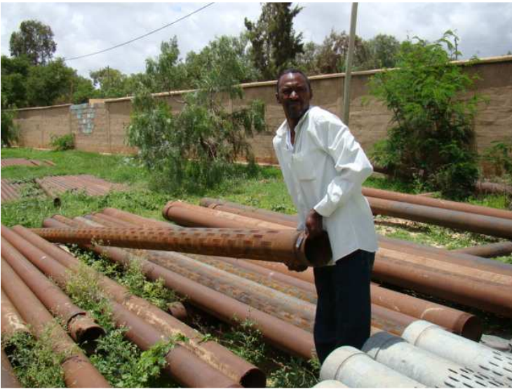
Fig. 2 – Remanentes de caños oxidados de paredes delgadas y ranurados con sierra.
